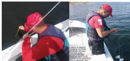
Figura 1.- Medición de temperatura del agua (izquierda) y de visibilidad de disco de Secchi (derecha).
