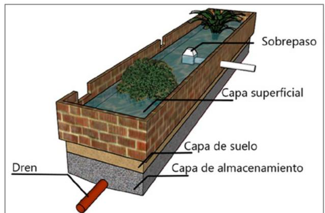
Figura 3.- Esquema de una celda de funcionamiento en serie.
