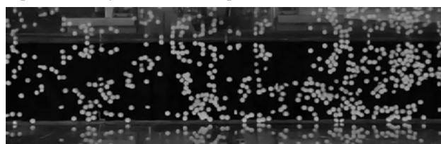
**Figura 1.-** Vista superior del campo de flujo horizontal sembrado con pellets de PP
