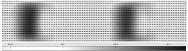
Figura 6.- Campo de flujo superficial  $U_{sm}$  (m/seg) medido con PTV sembrado con madera
