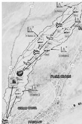
Figura 4.- Topología de la quebrada del diablo en el modelo RS Minerve
