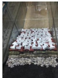
Figura 4.- Construcción del modelo físico.
