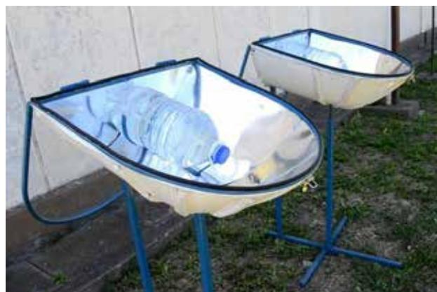
Figura 1.- Dispositivos utilizados para la desinfección de agua de lluvia
