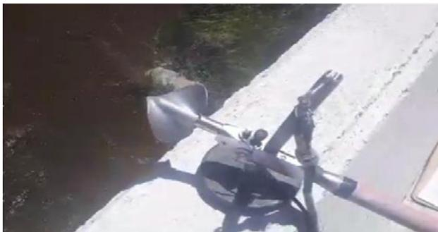
Figura 1.- Molinete mecánico
