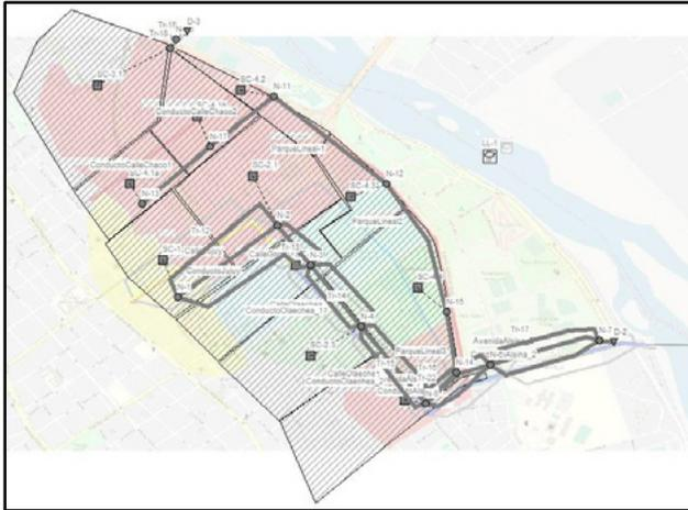
**Figura 2.-** Esquema topológico confeccionado para la simulación de los sistemas.
