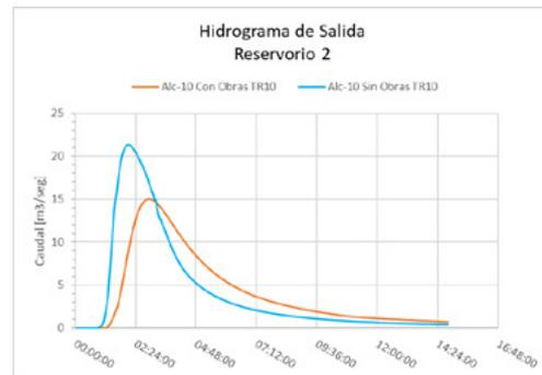
Figura 6.- Hidrograma de salida en Reservoirio 2 para tiempo de recurrencia de 10 años (TR10)
