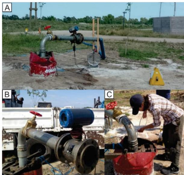
**Figura 1.-** A: Instrumental usado para el ensayo y manguera de desagüe utilizada para drenar el agua hacia la zanja. B: Detalle del caudalímetro y llave exclusiva. C: Tareas de medición de nivel con sonda freaticométrica durante el bombeo.
