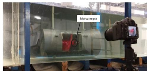
Figura 2.- Proceso de grabación de la turbina durante su ensayo
