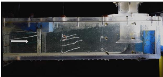
Figura 3.- Modelo físico -  $Q=27 \text{ m}^3/\text{s}$ . Ingreso a zona de aspiración
