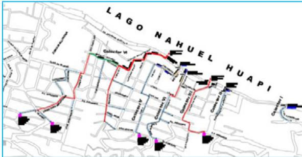
Figura 2.- Colectores pluviales a proyectar.
