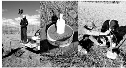
**Figura 2.-** Izquierda: Hoyadora con extensión del eje; Centro: Freatómetro con base cementada; Derecha: medición de profundidad y toma de muestras para análisis de agua.
