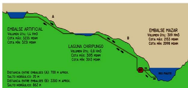
**Figura 4.-** Aprovechamiento de la topografía andina, laguna artificial y la laguna glaciárica de Chiripungo existente en la zona, para adaptar centrales hidroeléctricas reversibles, al complejo hidroeléctrico de presas sucesivas.
