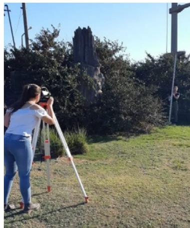
Figura 2.- Equipo del Laboratorio de Medio Ambiente realizando nivelación con nivel óptico
