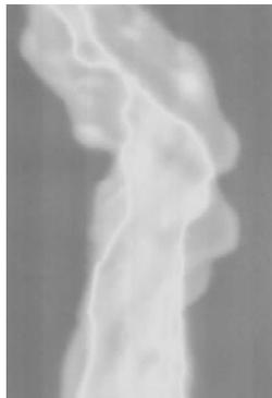
Figura 1.- Modelo Digital de elevaciones relevado en un canal a fondo móvil con 1 mm de resolución de pixel
