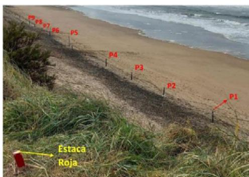
Figura 5.- Puntos de control para rectificación de imágenes de la estación Verde Mundo (Mar del Plata).
