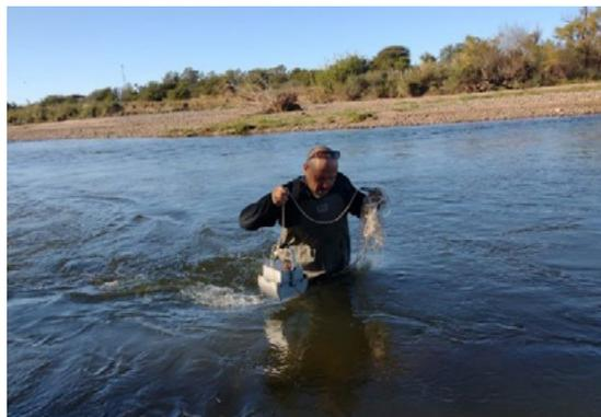
Figura 2.- Extracción de muestras con draga Ekman.
