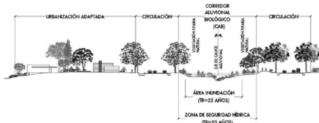
Figura 1.- Componentes del Corredor Biológico Aluvional (CAB)
