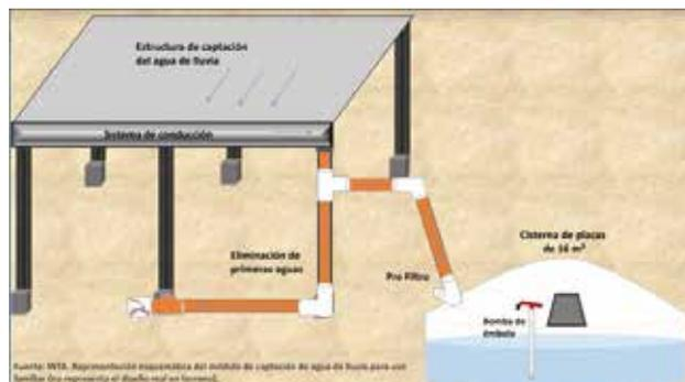
Figura 1.- Módulo estandarizado de captación de agua de lluvia
