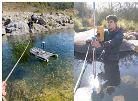
**Figura 1.-** Medición de escurrimiento en Río El Durazno, Córdoba con Perfilador Acústico Doppler (ADCP) (Izquierda). Medición de escurrimiento en Arroyo Las Mojaras con ADV (Derecha).
