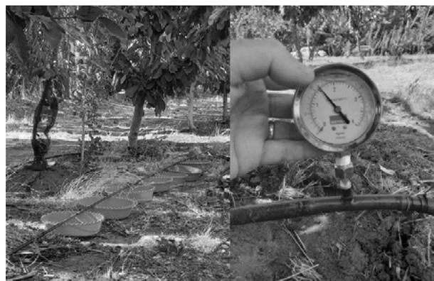
**Figura 1.** Medición de caudal total que afecta 1 planta y presión de funcionamiento de los emisores.
