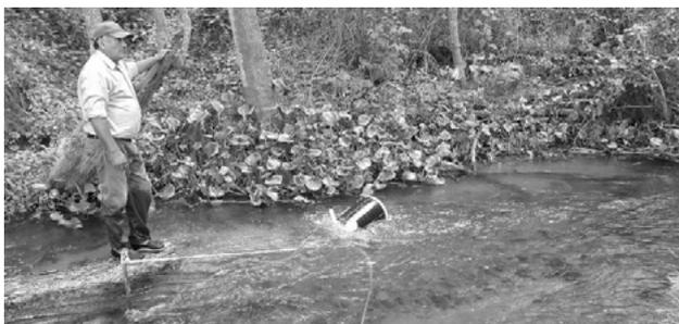
Figura 2.- Bomba de río instalada y en funcionamiento.
