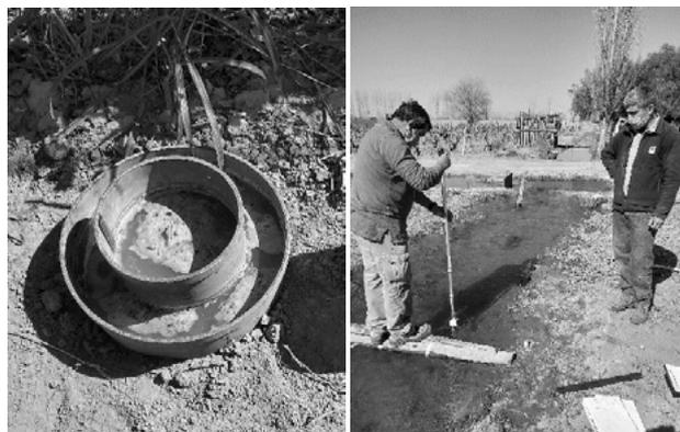
Figura 1.-A Anillos de infiltración. -B Medición de caudal ingresado (aforo) con molinete.
