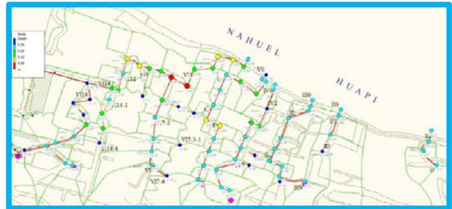
Figura 5.- Tirantes en los nodos de los colectores simulados.
